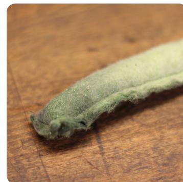
Abgenutzte Sammlertrockner (oder Trockenmittelpatronen) führen häufig zu einer Verstopfung des Innenrohrs des Kondensators
