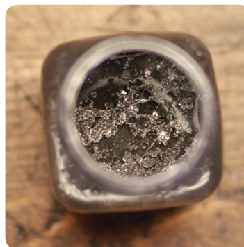
Aus einem festgefressenen Kompressor abgelassenes Öl. Die sichtbaren Verunreinigungen sind im gesamten System verteilt, einschließlich dem Kondensator.
