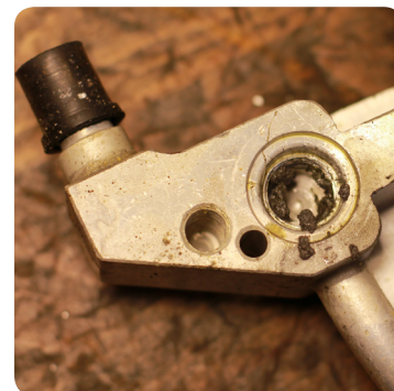
Sichtbare Verschmutzung am Zufluss des Kondensators
