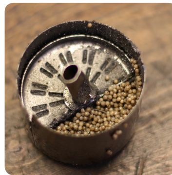
储液干燥器内部浸湿、油腻的干燥剂层
