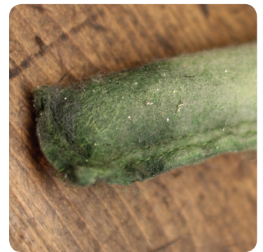
老化空袋干燥器——干燥剂被系统中过量添加的紫外线剂浸透
