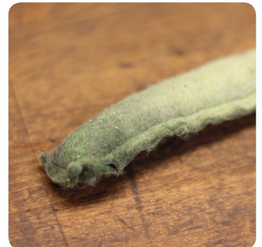
磨损严重的储液干燥器（或袋装干燥剂）通常会造冷凝器内部管路阻塞
