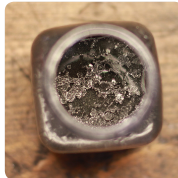
咬死的压缩机排出的润滑油。整个系统包括冷凝器都存在可见的污染。
